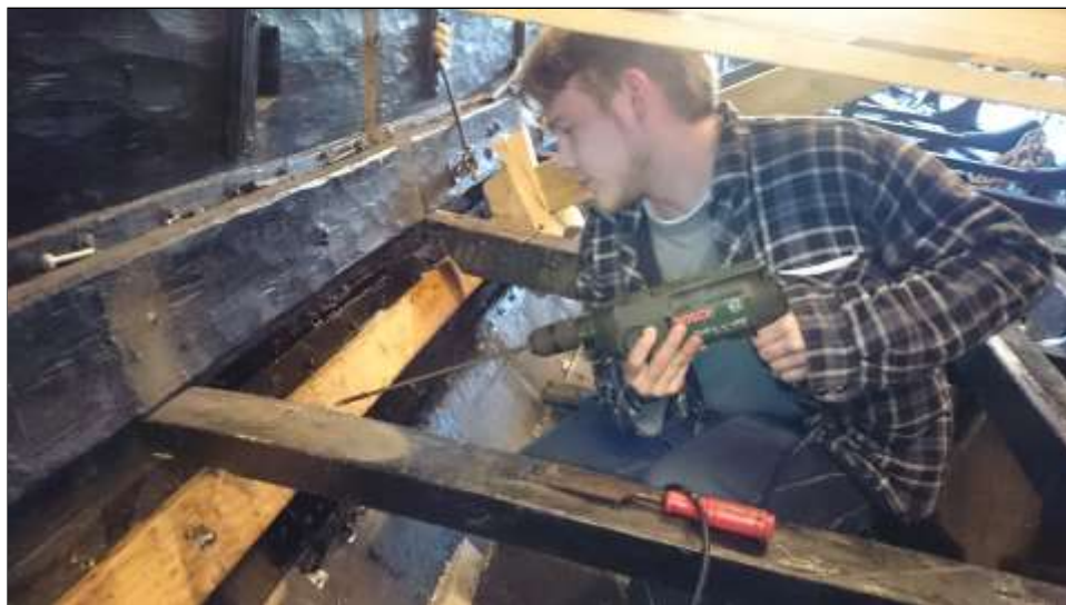
Så laves der hul så vi ikke behøver at lænse; vandet kan selv løbe ud af skibet!
