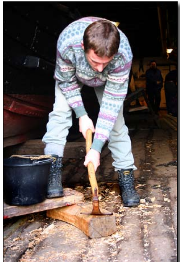
Et knæ fremstilles - med skarøkse
